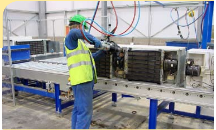
Rozoberanie starých chladničiek na recyklačnej linke
